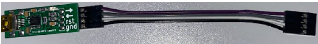
Figure 35 : Dongle de téléversement du programme vers le MCU
