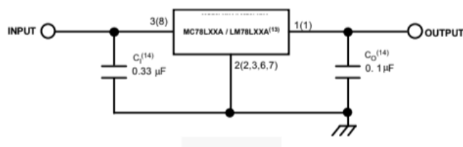
Figure 8: Schéma électrique recommandé par la datasheet du régulateur
