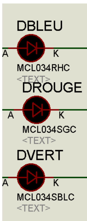
Figure 6: Montage de la partie action des LED
